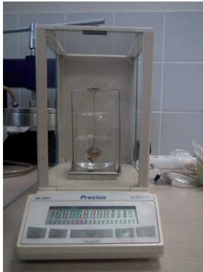
2.5. attēls. Blīvuma mērīšana koksnes paraugam. Figure 2.5. Density measurement of a wood sample.
