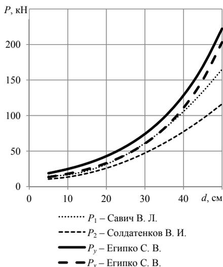
Рис. 3. Изменение усилий корчевки от диаметра пня
