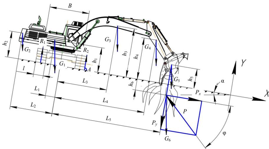
Рис. 4. Расчетная схема корчевателя:
