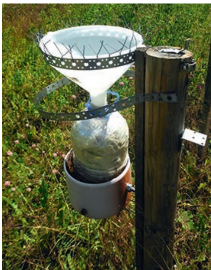
2.7. att. Aprīkojums atmosfēras nokrišņu paraugu ņemšanai
