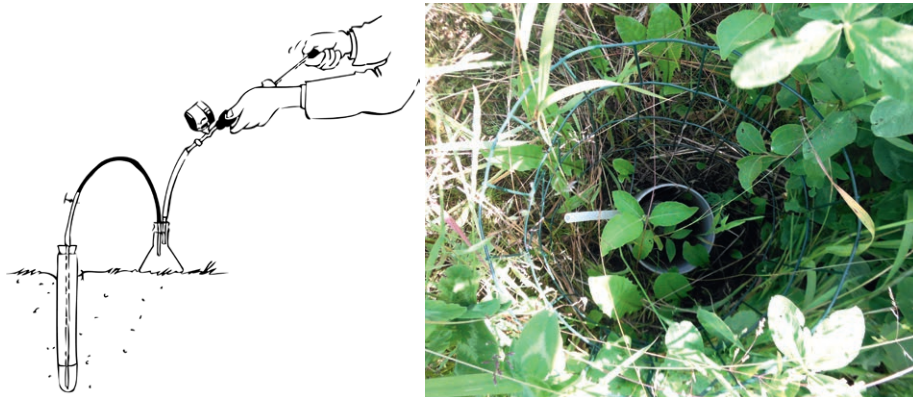
2.6. att. Vakuuma lizimetrs augsnes ūdens paraugu ņemšanai
