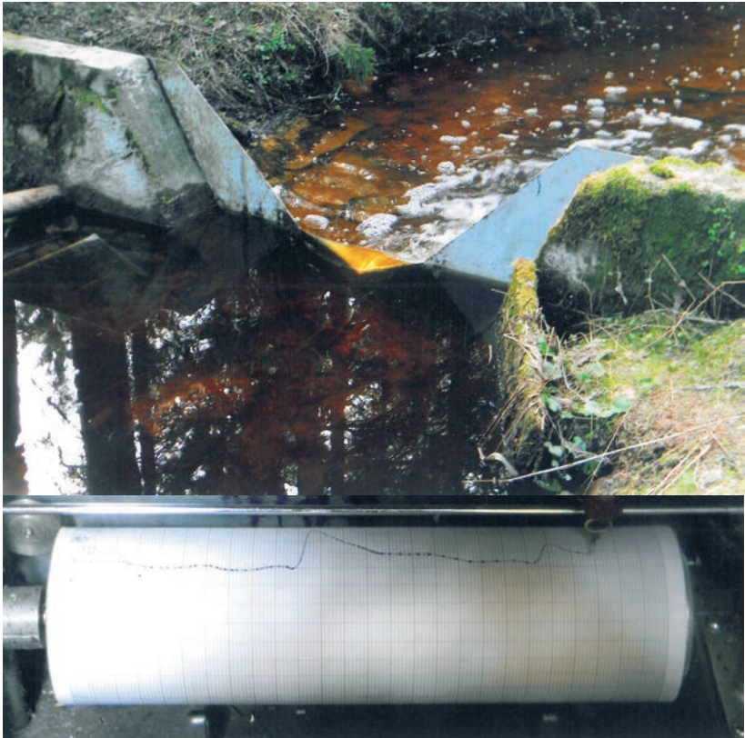
Kopš 1967. gada ierīkotā taisnleņķa pārgāze uz maģistrālā grāvja, un ūdens līmeņa mērījumi ar koriģēto “Valdas” pašrakstītāju.
