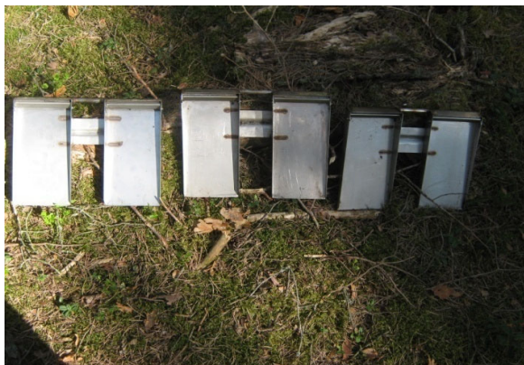
Att. 8: Nulles spiediena lizimetri pirms uzstādīšanas 9 .
