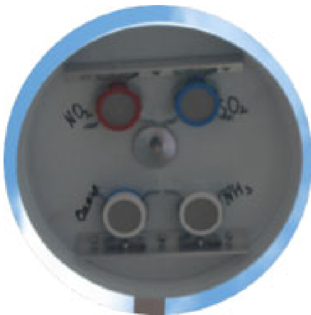
Att. 5: Membrānas tipa pasīvie gaisa paraugu savācēji 6 .
