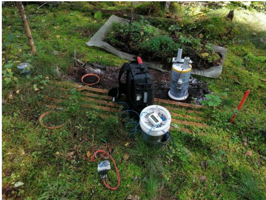
6.att. Augsnes elpošanas mērījumu process ierīkotajos parauglaukumos.
