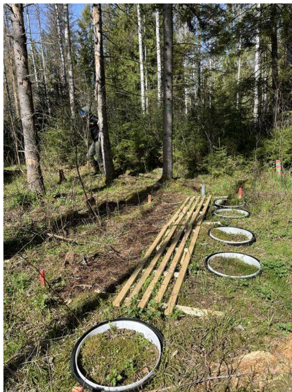
Att. 2.2. Augsnes heterotrofās elpošanas mērīšanas parauglaukums (kreisajā pusē) un SEG paraugu ievākšanas parauglaukums (labajā pusē)
