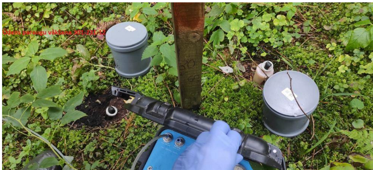
Att. 1.2. Lizimetri gruntsūdens paraugu ievākšanai
