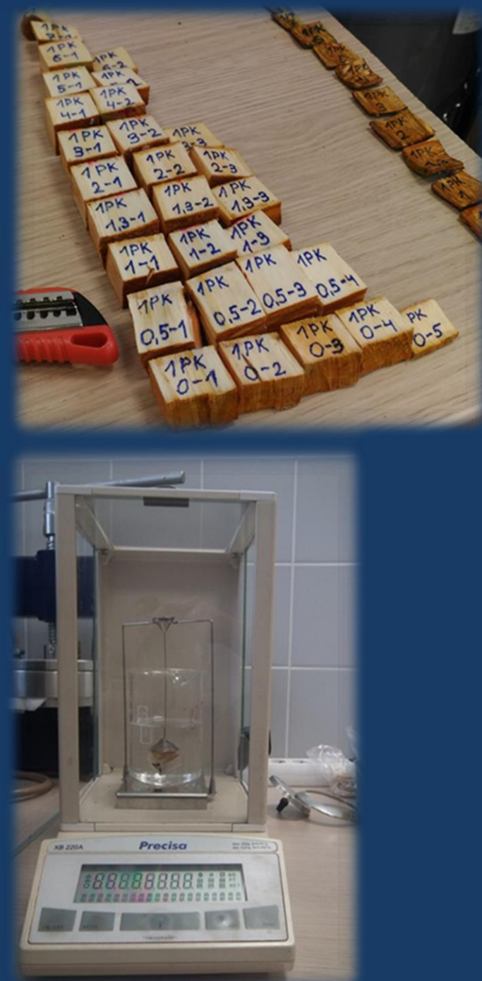
2. attēls. Blīvuma paraugu novietojums šķērsriezuma ripās, raksturojot stumbra blīvuma variēšanu garenvirzienā un šķērsriezumā
