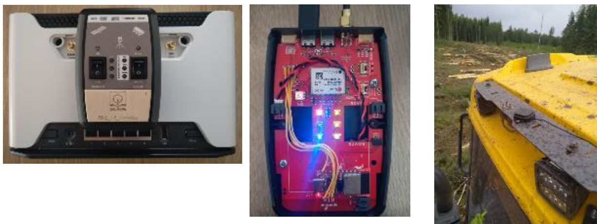
Att. 2.1. RM2 sistēma (kreisajā pusē RTK, vidū datu apstrādes bloks (RM2) un labajā pusē GNSS antena)
