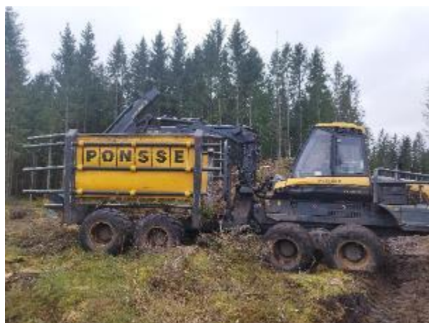
Att. 1.13. Biomassas pievešanai pielāgots forvarders
