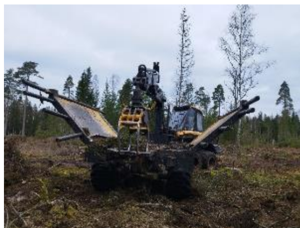
Att. 1.13. Biomassas pievešanai pielāgots forvarders
