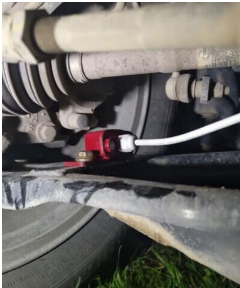
Att. 3.2. Akselerometrs uzstādīts uz auto šķērsviras
