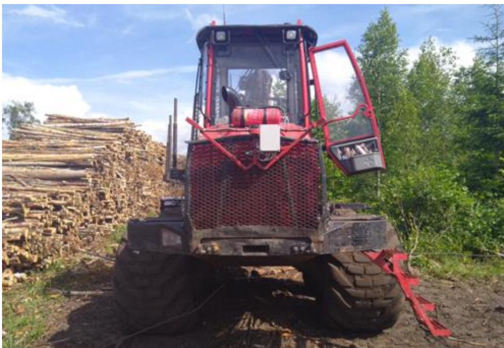
Attēls 2.2. RM1 sensoru novietojums uz forvardera.
