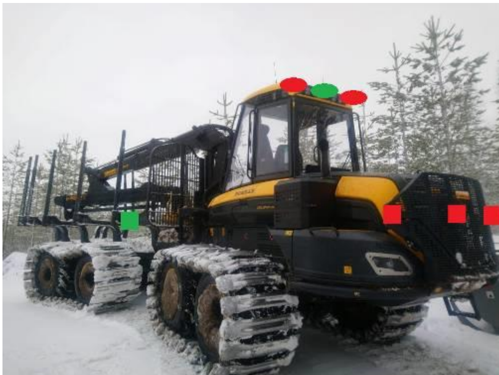
Attēls 1.17. Risu mērīšanas sensoru izvietojums 1. un 2. paaudzes iekārtās
