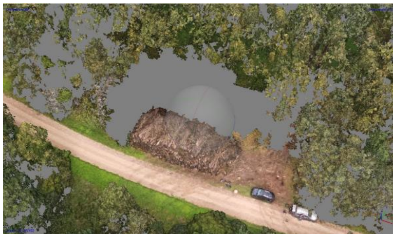
Attēls 1.7. Fotogrammetrisks biokurināmā krautuves punktu mākonis (Dense Cloud)
