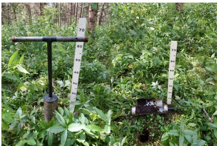
**1.3.3. att. Augsnes paraugu ievākšana ar speciāli izgatavotu cilindru.**
