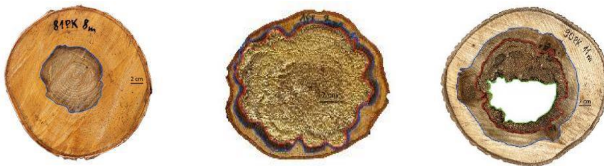
Attēls 3.3. Trupes ietekmētā laukuma noteikšana stumbra šķēsgriezuma ripās. Zils – iekrāsojums, sarkans – mīkstā trupe, zaļš – dobums
