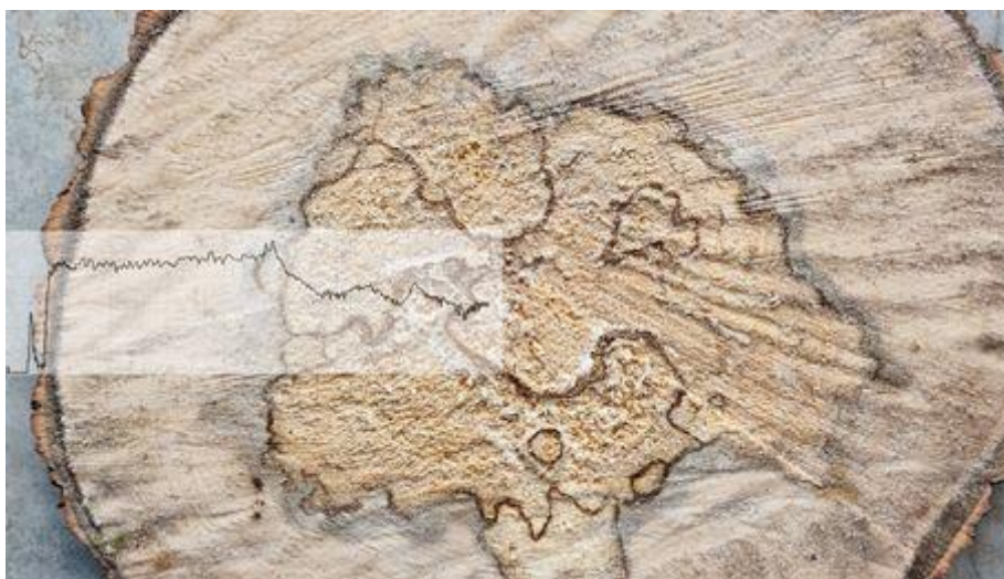
Attēls 17. Rezistogrāfa mērījums uzrāda blīvuma samazinājumu, kas norāda uz mīkstās trapes klātbūtni stumbrā.
