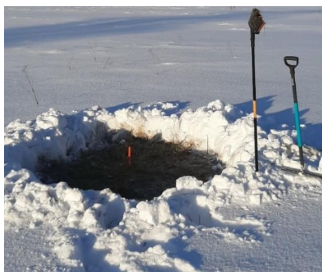
2.9. attēls. Augsnes temperatūras mērījumi attīrītas zemes virskārtas apstākļos
