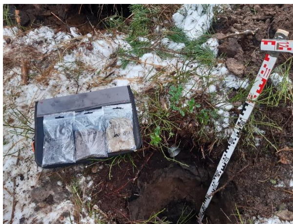
2.15. attēls. Augsnes blīvuma un mitruma paraugu ievākšana ar 100 ml tilpuma cilindru
