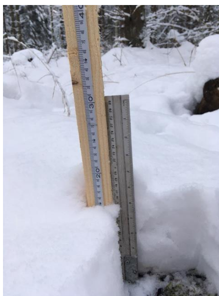
2.8. attēls. Sniega segas biežuma mērīšana ar pastāvīgi novietotu mērlatu
