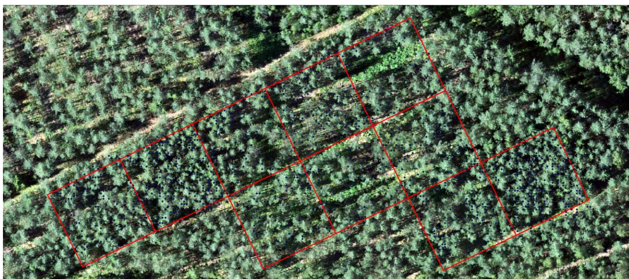
3.2.3. attēls. Piemērs pētījumu objektu ortofotomozaīkai 110-238-5 objektā. Mozaīka veidota no drona RGB datu failiem.
