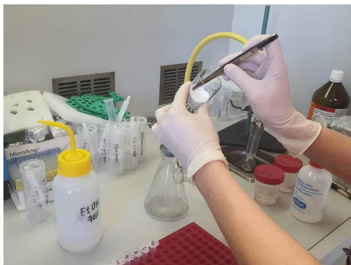
8. attēls. DNS saturoša parauga filtrēšana, izmantojot filtrpapīru, Bihnera piltuvi un Bundzena kolbu. Foto: B. Krivmane.
