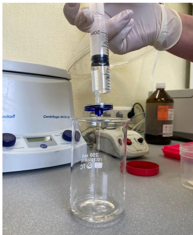
7. attēls. DNS saturoša parauga filtrēšana, izmantojot 0.20 µm filtru un 20 ml medicīnisko šļirci bez adatas. Foto: V. Lazdiņa.
