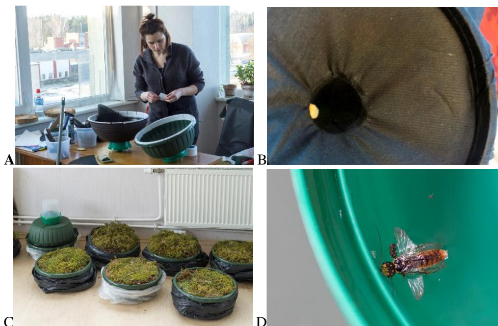
3.3.3.1. attēls. Zemsedzes slazdu konstruēšana un testēšana laboratorijā: A) zemsedzes slazdu pamatnes veidošana, B) Pamatnes iekšpuse, C) Augsne ar kāpuriem slazdu efektivitātes novērtēšanai laboratorijā, D) Uztvērējā noķertā tīklapsene. (A. Šmita foto).
