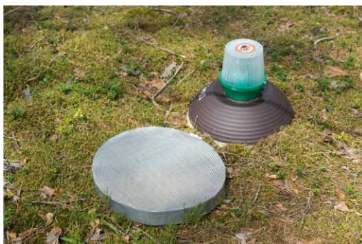
3.3.2.2. attēls. Zemes slazda pārsegis, kas izgatavots no metāla sieta blakus zemsedzes slazdam. Metāla sieta acs izmērs 0,4 mm, kas ir pietiekoši mazs, lai kontrolēs zemes slazdos nenonāktu jauni kāpuri vai parazitoīdi. Pa labi - nosegts zemes slazds.
