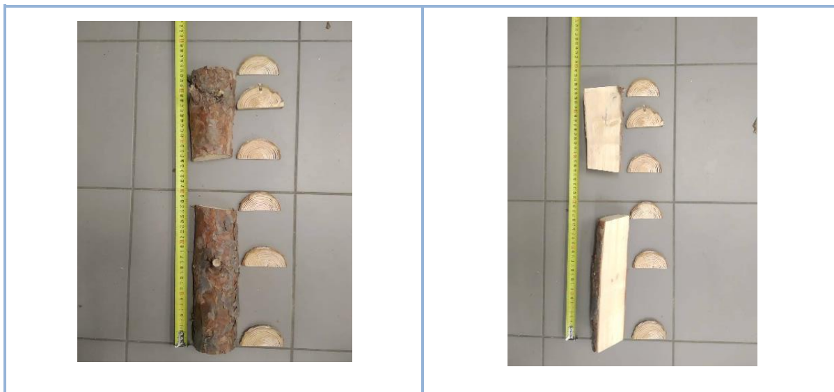
Att. 22. Gadskārtu platuma mērīšanai sagatavotie garengriezuma un šķērsriezuma paraugi.
