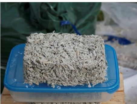
Hidratētā kaļķa un kaņepju spaļu sajaukumu ar ūdeni kas tiek dēvēts par kaņepju spaļu betonu © SIA Hemp Eco Systems Latvia publicitātes foto
