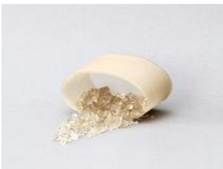
Biokompozīta granulu pamātā ir termoplastiskā ciete un dažādas videi draudzīgas piedevas © Bioplastic Solutions Granulas
