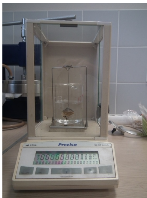
6. attēls. Blīvuma klucīšu mērīšana ar laboratorijas svāriem aprīkoti ar speciālu blīvuma mērīšanas iekārtu.
