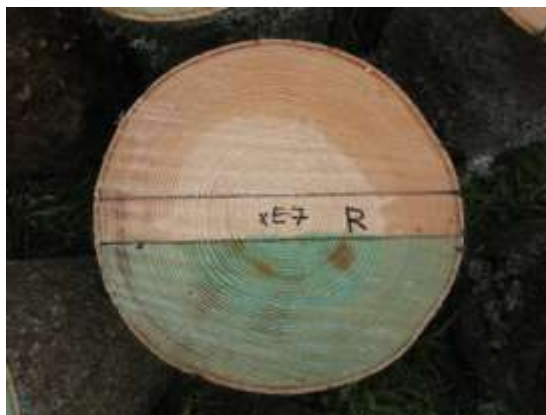
8.1. attēls. Ar "Rotstop" apstrādāta blukīša virsma (zilgans iekrāsojums).
