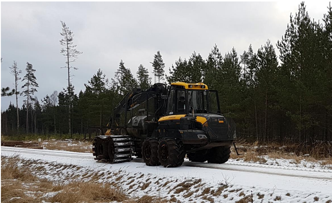
Att. 15: Ponsse Buffalo forvarders ar ekskavatora tipa ķēdēm uz aizmugurējā tandēma 12 .
