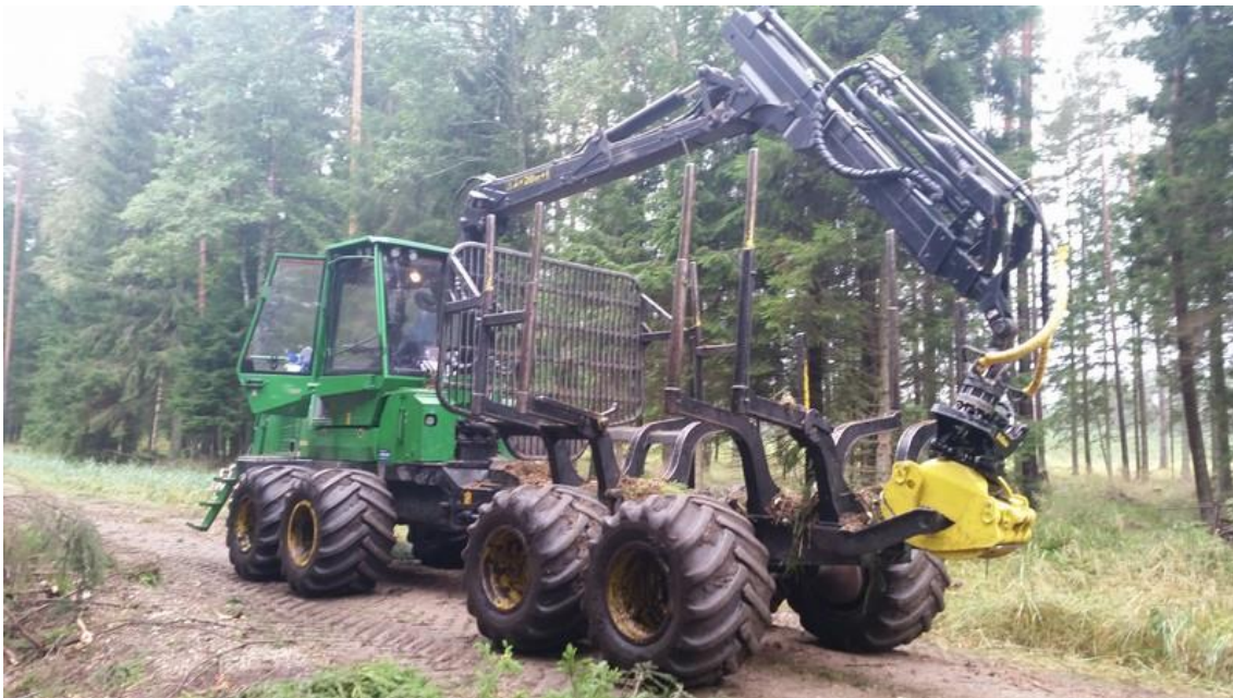
Att. 37: John Deere 810 D forvarders ar greiferi ar pacelšanas mehānismu.
