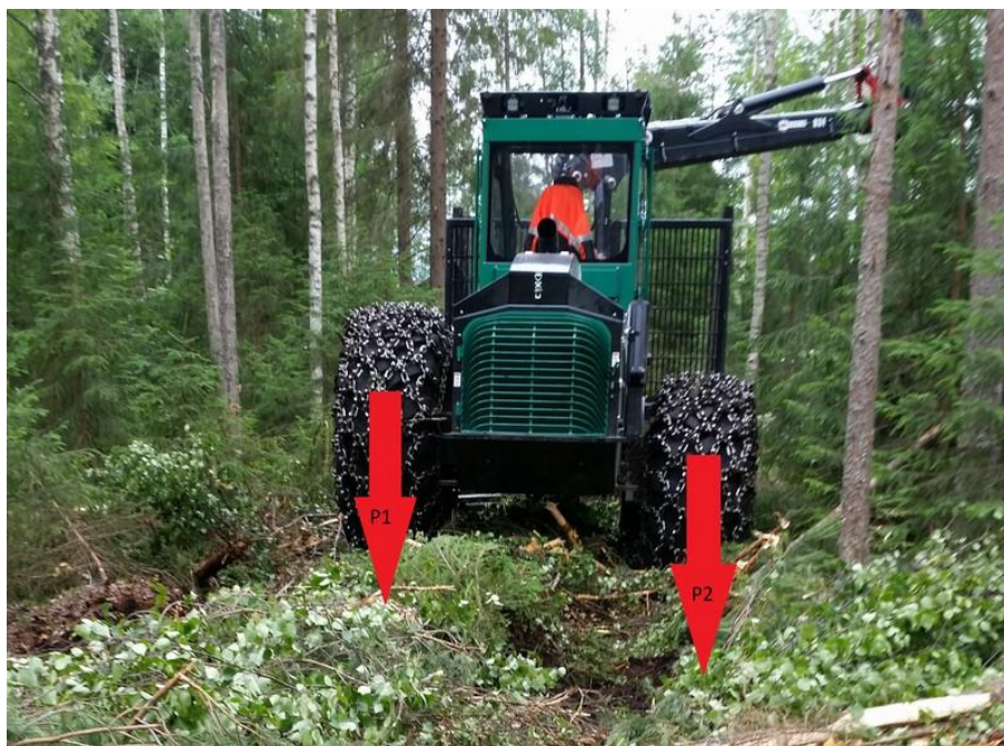
Att. 24: Forvardera ProSilva spiediens uz augsni sadalījums pa asīm P1=P2 un P3=P4.
