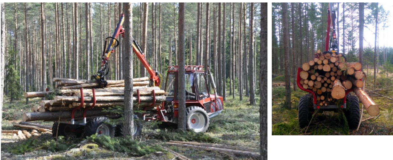
Att. 21: Kranman Bison10000 6WD forvarders ar vidēju (2,2 tonnas) kravas piepildījumu 19 .
