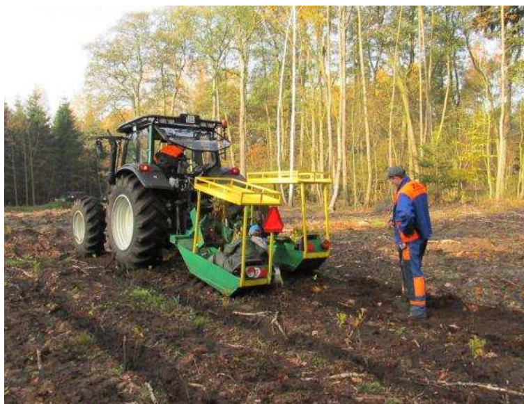
Attēls 32 Čehijā ražotā stādīšanas mašīna RZS-2 izmēģinājumos Polijā ( http://www.pila.lasy.gov.pl )
