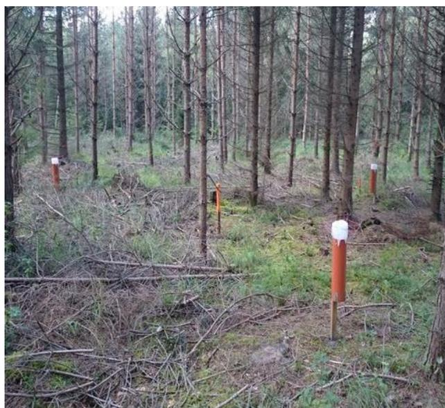
**Att. 73: Nokrišņu ūdens savācēju un lizimetru izvietojums parauglaukumā.**
