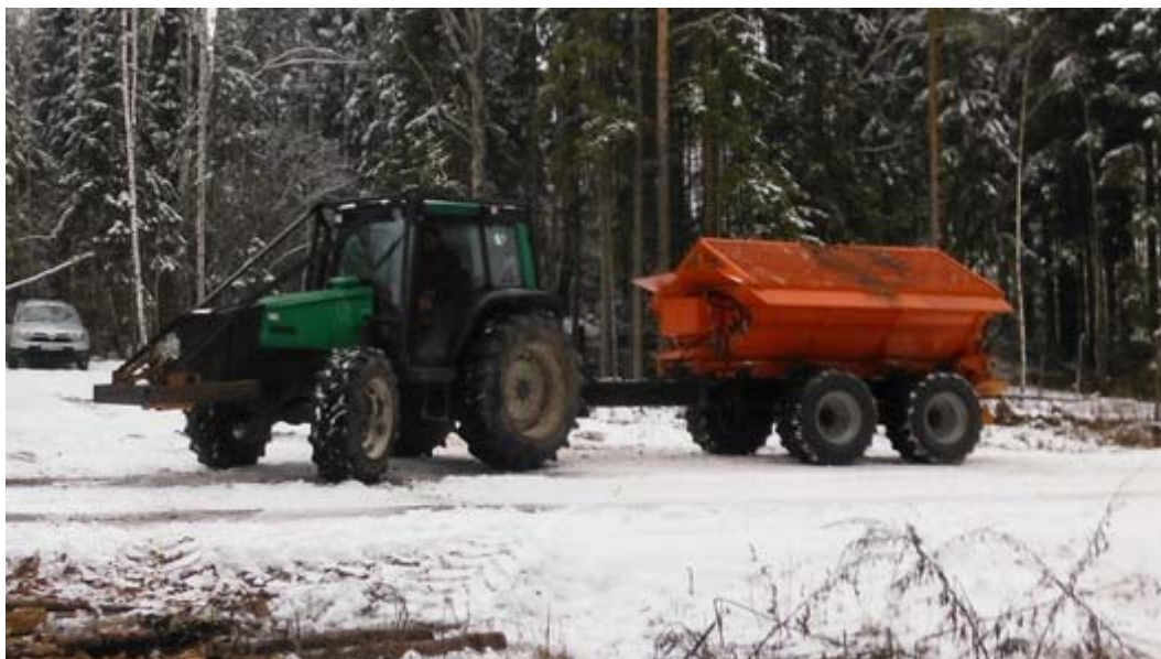
Att. 1: Valtra 6350 traktors un modulārais koksnes pelnu klieštājs 2 .
