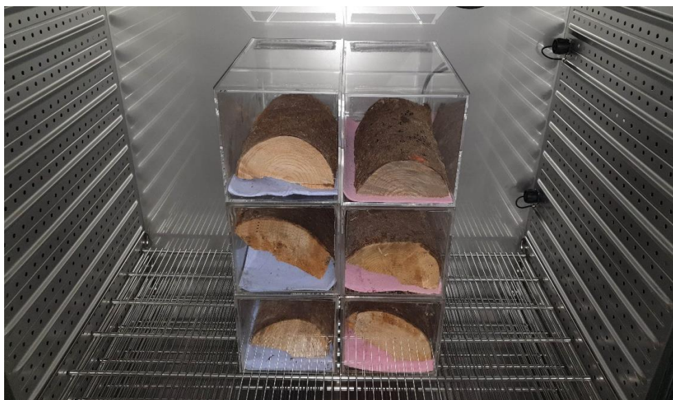
4.2. attēls. I. typographus vaboļu audzēšana uz egles klimata kamerās laboratorijā (foto: I. Siliņš)
