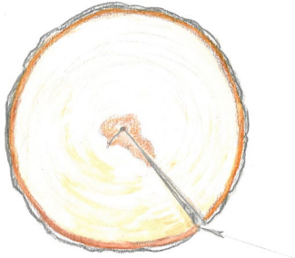
Žūšanas plaisa skar mizu – finierklucis tiek brāķēts.
