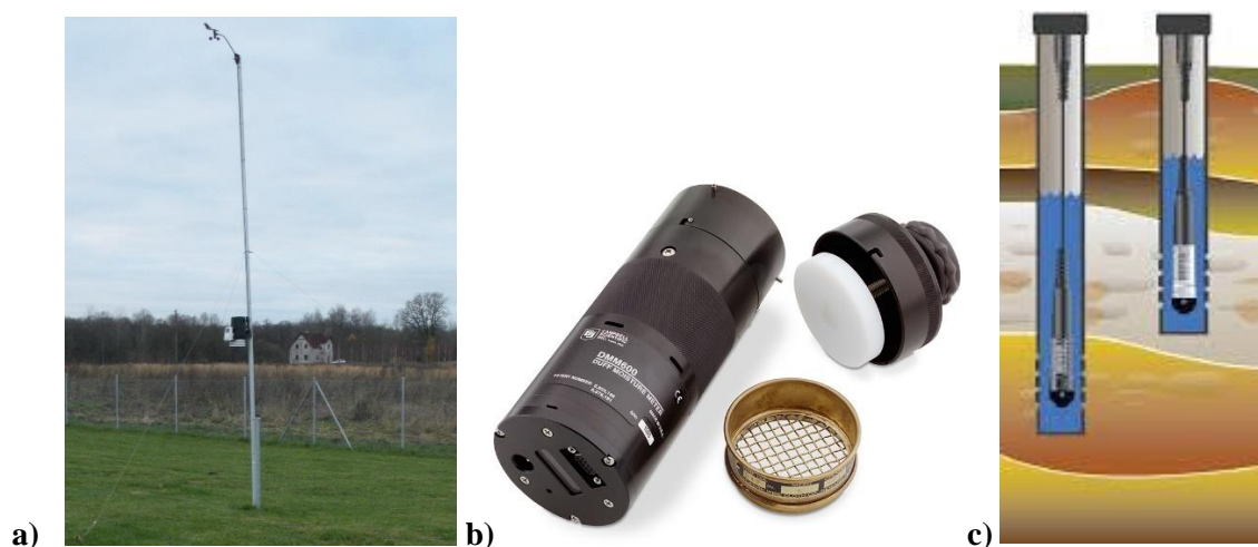
2.1.att. Gaisa, augsnes un nobiru parametru uzmērīšanas komplekts: pārvietojamā meteostacija (a), dufmetrs (b) un gruntsūdens līmeņa mērīšanas akā uzstādīts mērījumu sensors (c) ( https://www.campbellsci.com ; http://www.novamatrixgm.com ).
