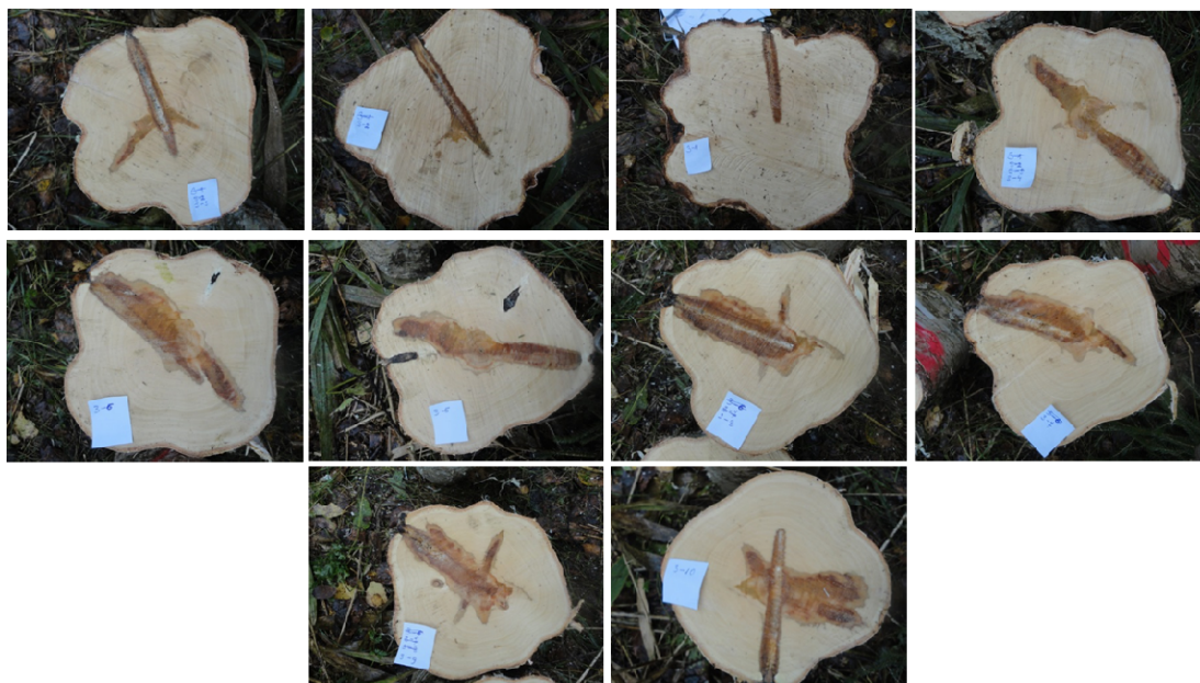
2. attēls. Koksnes iekrāsojums pēc dzīva koka inokulēšanas ar sēņu tīrkultūrām.
