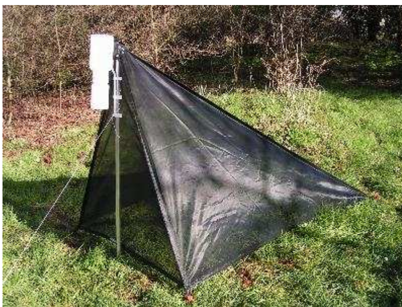
18.1. attēls. „Izskreju” lamatas ( emergence trap ) (pēc http://entomology.org.uk/products.htm )
