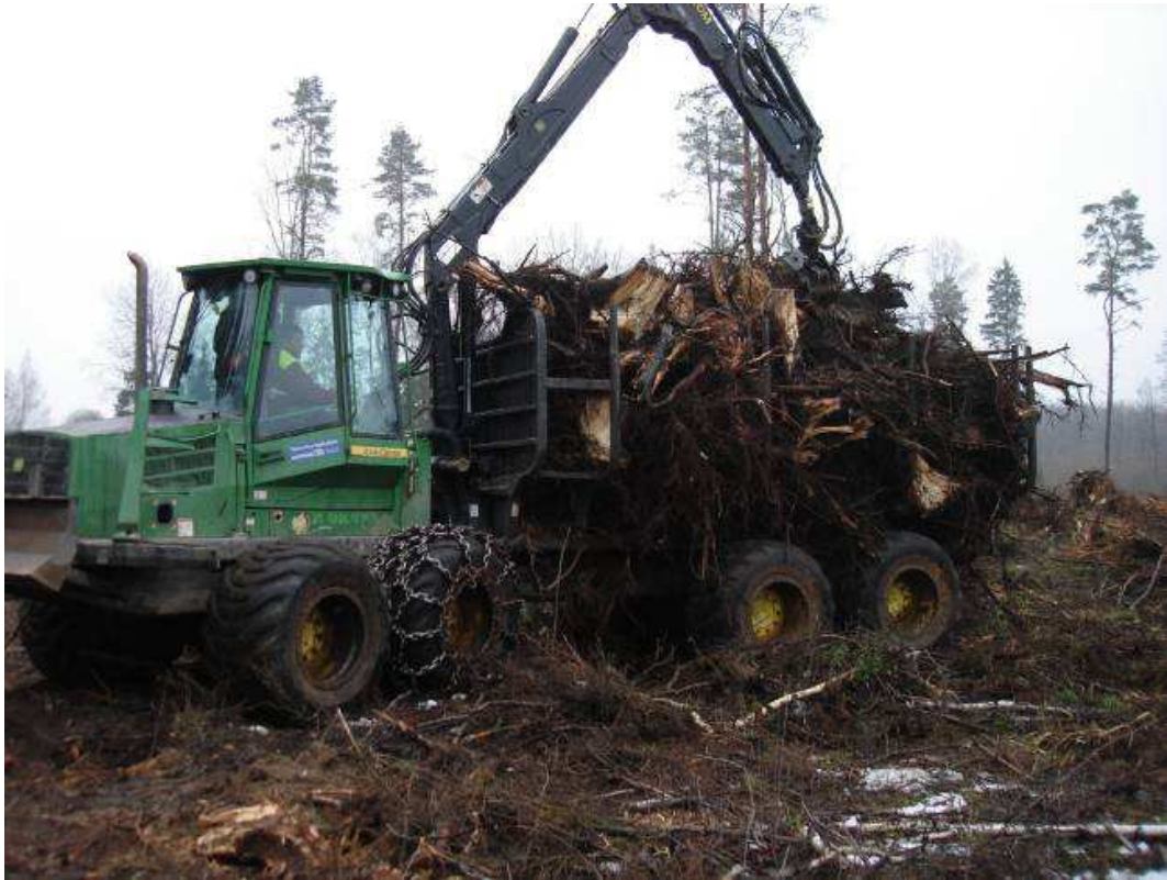
1. attēls. Izmēģinājumos izmantotais pievedējtraktors JOHN DEERE 1110D.
