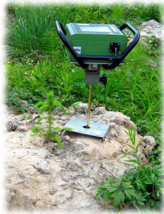
16.attēls. Augsnes pretestības noteikšana ar penetrolgeru.
