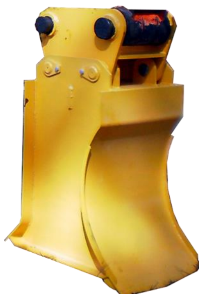
5.5. att. LVMI Silava izstrādāta pacilu veidošanas darba galva MPV-600 (FOTO: A. Lazdiņš).
