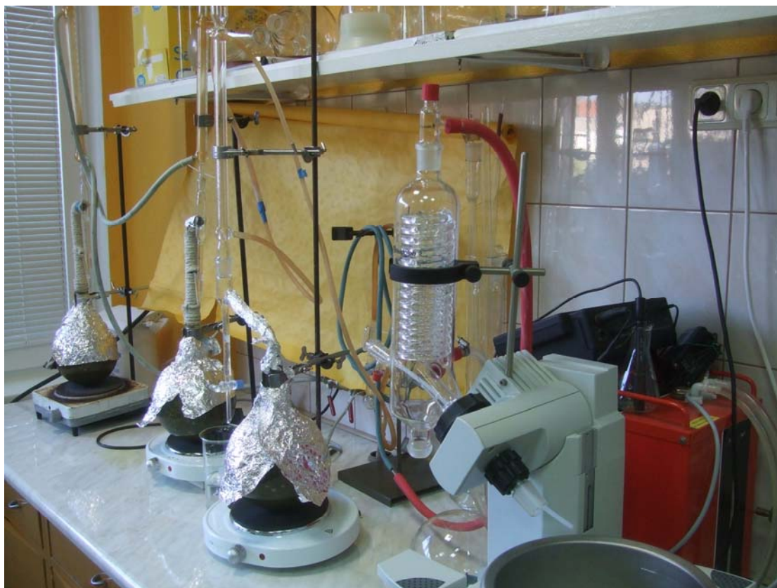
3. attēls. Koku zaleņa ēterisko eļļu kvantitatīvā noteikšana laboratorijā
