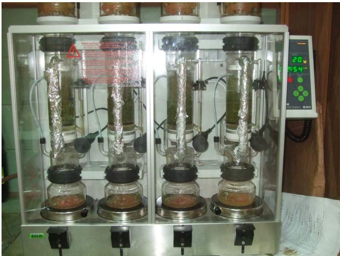
7. attēls. Ekstrakcijas iekārta ekstraktvielu iegūšanai laboratorijā.
