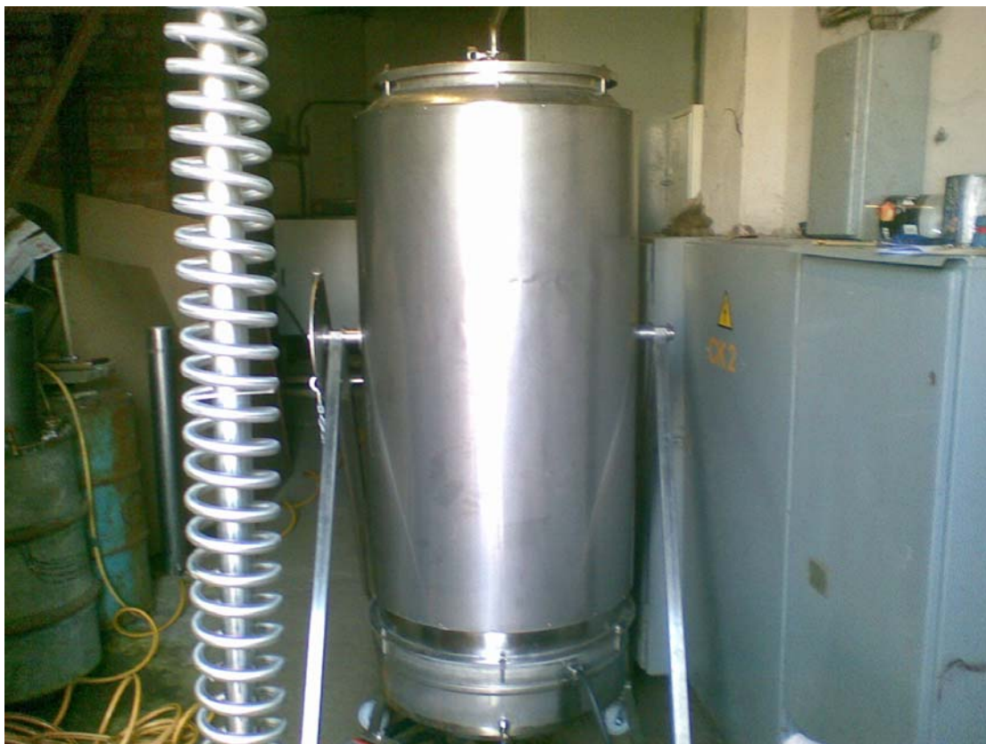
4. attēls. Pilotiekārta augu materiāla ēterisko eļļu iegūšanai.
