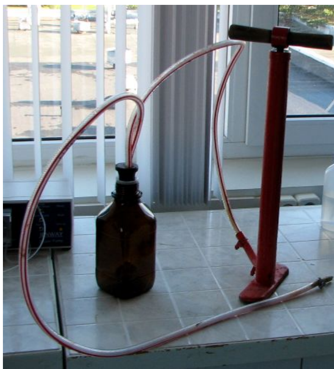
Att. 6 Sūknis augsnes ūdeņu izsūknēšanai.
