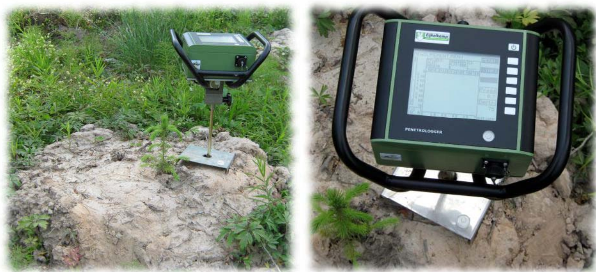
Att. 22 Augšnes pretestības mērīšana
