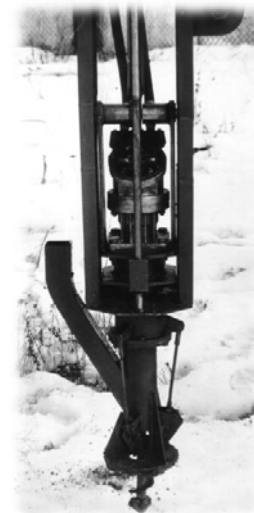
Att. 1 Diskrētās darbības ietvarstādu stādāmās mašīnas "SBS-50" (Latvija) ar piekabi rezerves stādāmā materiāla transportēšanai, izmēģinājumi MPS "Kalsnava", 1980. gads
