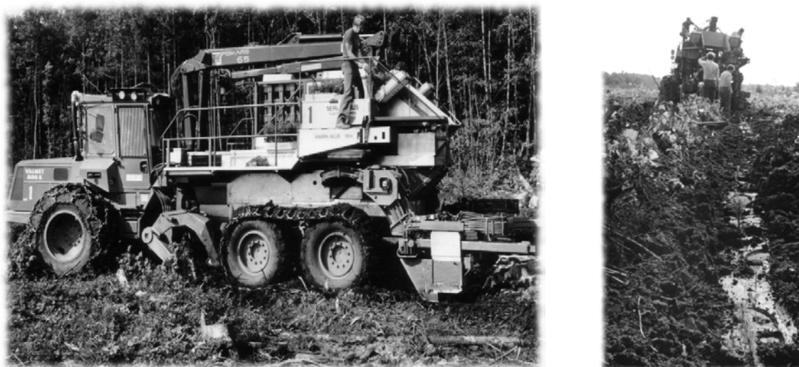
Att. 4 Meža stādāmais kombains “SERLACHIUS” ar vienlaicīgu augsnes gatavošanu uz bāzes mašīnas “VALMET 886 K” (Somija), izmēģinājumi Ogres MRS 1983. gads
