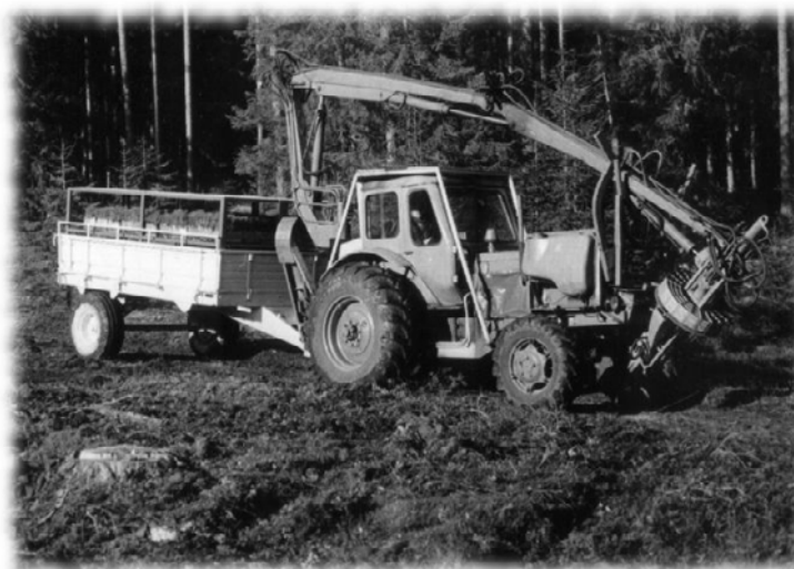
Att. 1 Diskrētās darbības ietvarstādu stādāmās mašīnas "SBS-50" (Latvija) ar piekabi rezerves stādāmā materiāla transportēšanai, izmēģinājumi MPS "Kalsnava", 1980. gads
