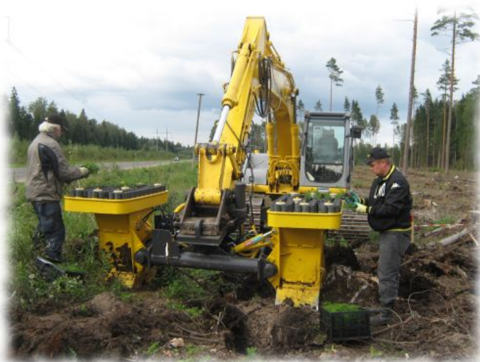
Att. 10 M-planter - ietvarstādu stādāmā iekārta (foto D.Lazdiņa)
