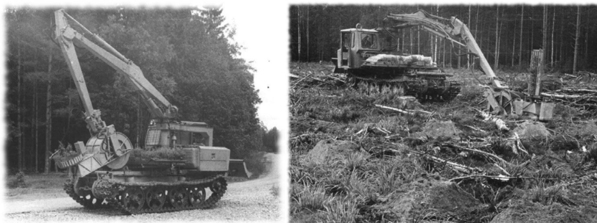
Att. 3 Ietvarstādu stādāmais kombains “KLM-1” (Krievija) uz kāpurķēžu traktora “TB-1” bāzes, kas veidoja pacilas un vienlaicīgi stādīja stādus, 1983. gads
