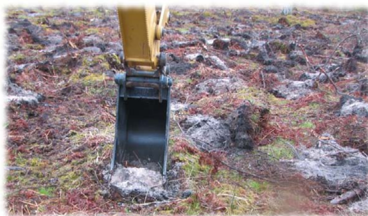
Att. 47 Ar ekskavatora kausu sagatavotas pacilas
