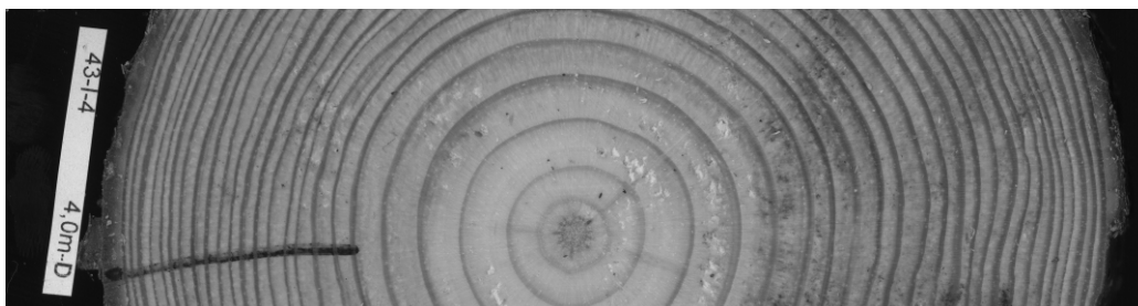
4.1. attēls. Gadskārtu platuma mērīšanai sagatavots noskanēts koka ripas paraugs.
