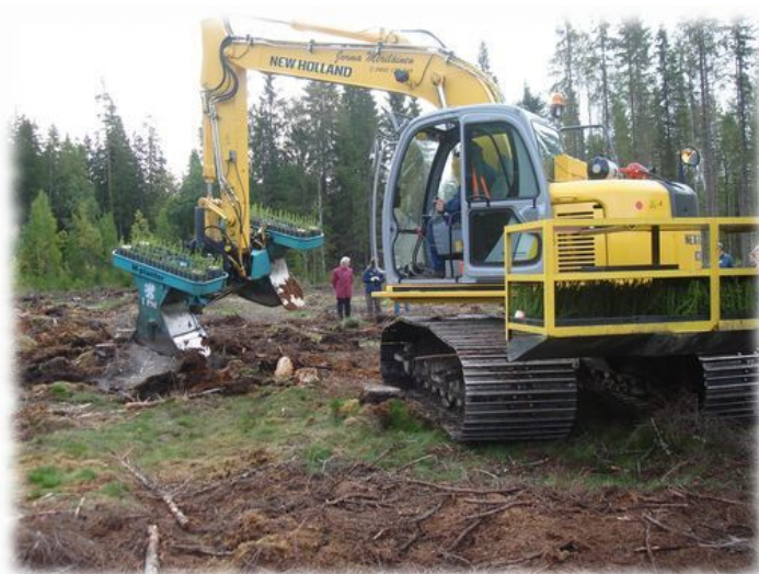
Att. 14 M-planter - ietvarstādu stādāmā ierīkārta (foto D.Lazdiņa)
