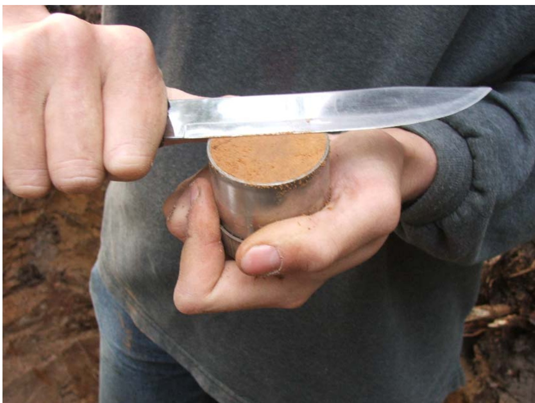
27. attēls. Augsnes blīvuma paraugu noņemšanas cilindrs ar ievākto augsni.
