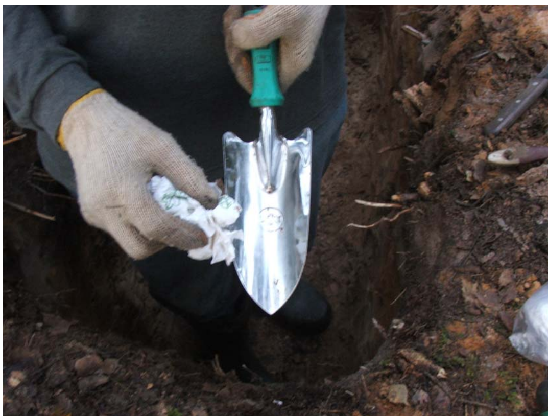
23. attēls. Augsnes paraugu ņemšanas lāpstiņas pēc katra slāņa parauga noņemšanas rūpīgi jānotīra.
