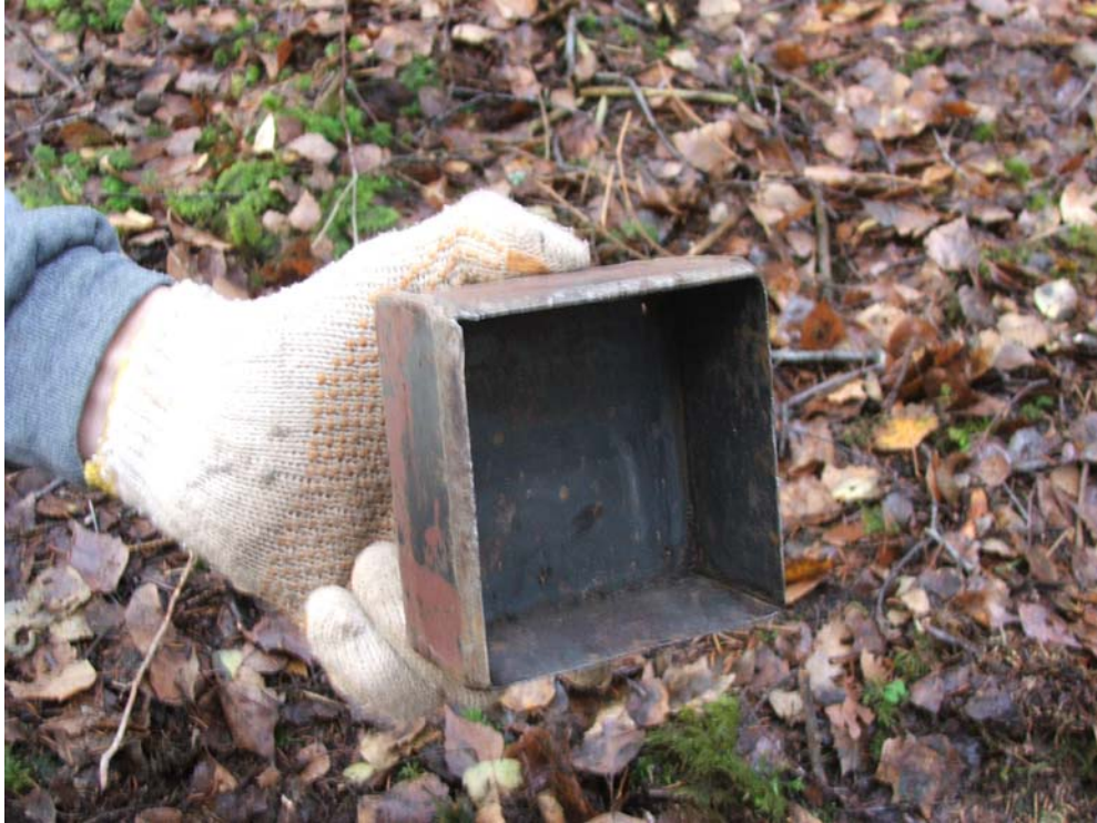
16. attēls. Metāla kaste O horizonta blīvuma paraugu noņemšanai. Skats no apakšpusēs.
