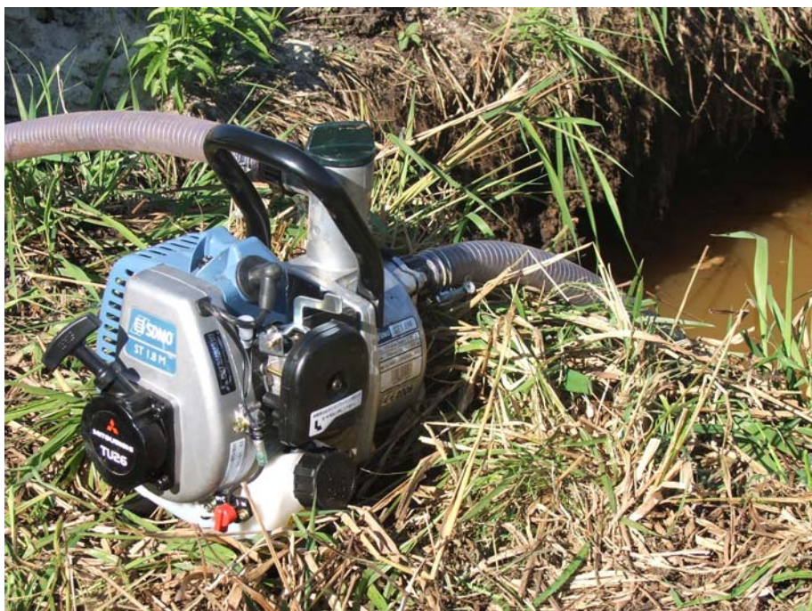
15. attēls. SDMO firmas benzīna divtaktu motorsūknis ar Mitsubishi TU26 motoru (sūkņēšanas jauda 115 litri minūtē, svārs 3 kg).
