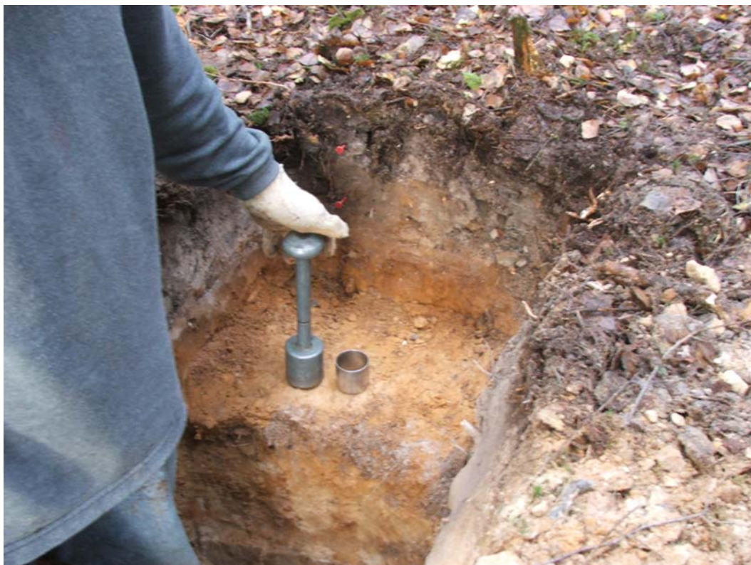
26. attēls. 100 cm 3 cilindrs augsnes blīvuma paraugu noņemšanai kopā ar palīgierīci tā iedzīšanai augsnē.
