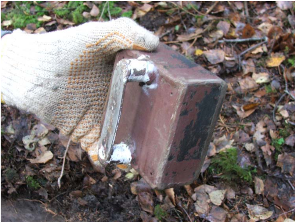
16. attēls. Metāla kaste O horizonta blīvuma paraugu noņemšanai. Skats no apakšpusēs.
